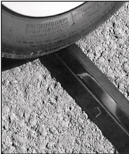
Sensor piezoeléctrico tipo superficial en operación
