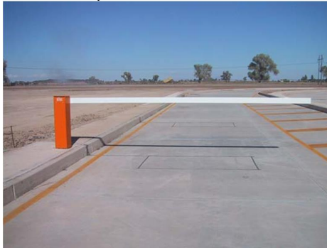
Barrera de 4 m de longitud con dos lazos inductivos
