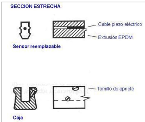
Sensor piezoeléctrico y caja de tipo estrecho (Caja 30 mm ancho x 30 mm fondo)
