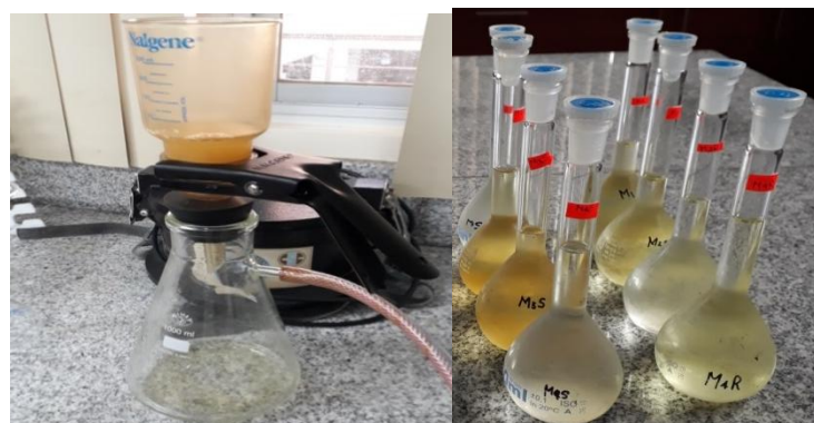
Figura 14. Filtrado y enrasado de muestra de raíces Fuente: Echeverría, K. 2019.
