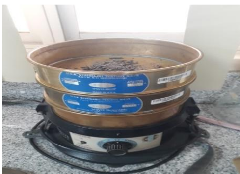
Figura 11. Tamizado de sedimentos Fuente: Echeverria, K. 2019.
