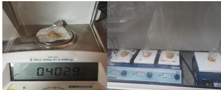
Figura 13. Pesado y digestión de raíces Fuente: Echeverría, K. 2019.
