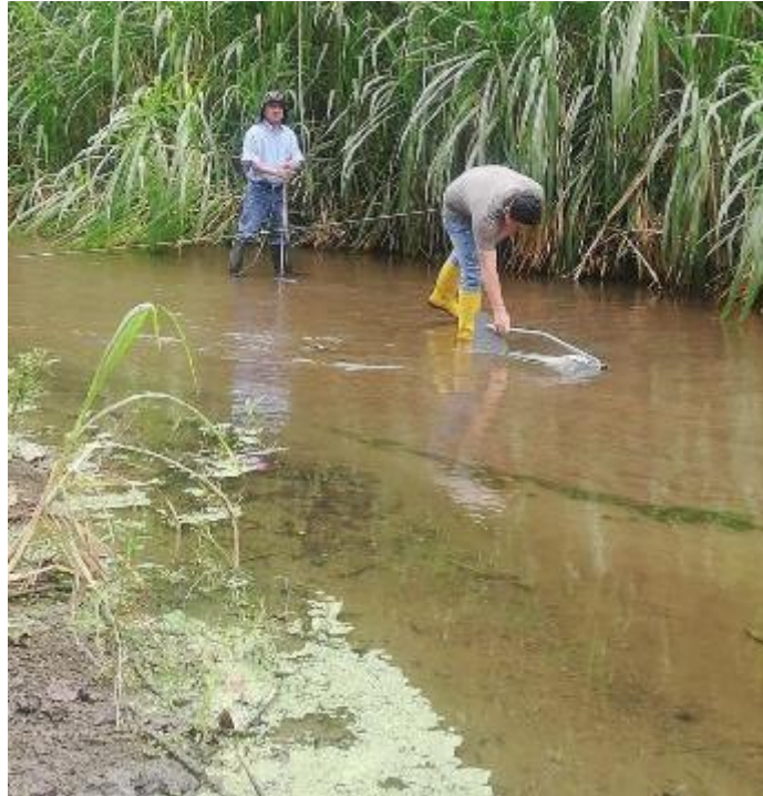
Medición de Aforo líquido superficial (método Molinete).
