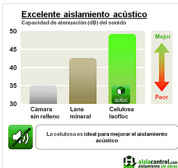
Figura 2.8: Grados de aislamiento acústico de distintos materiales
