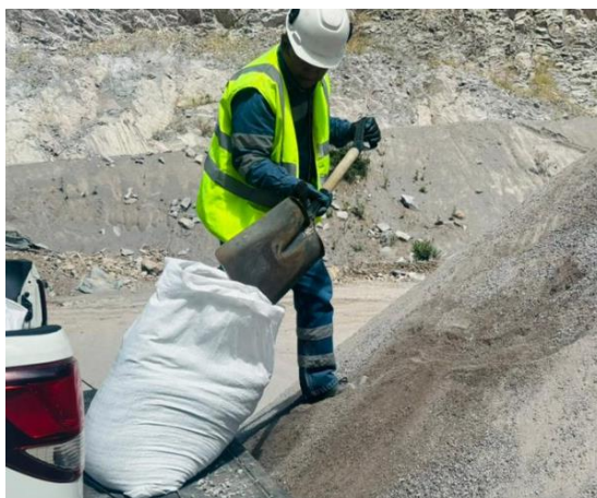
Ilustración 5 Toma de muestras de Stock de material
