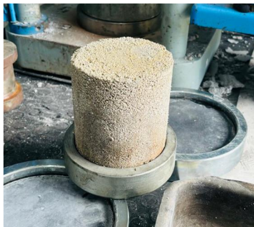
Ilustración 19 Briqueta de Suelo-Cemento para Ensayo de Compresión Simple
