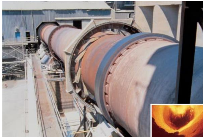
Ilustración 25 Horno Rotatorio para Manufactura del Clinker
