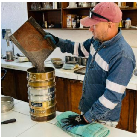
Ilustración 12 Ensayo de Análisis Granulométrico de los Áridos
