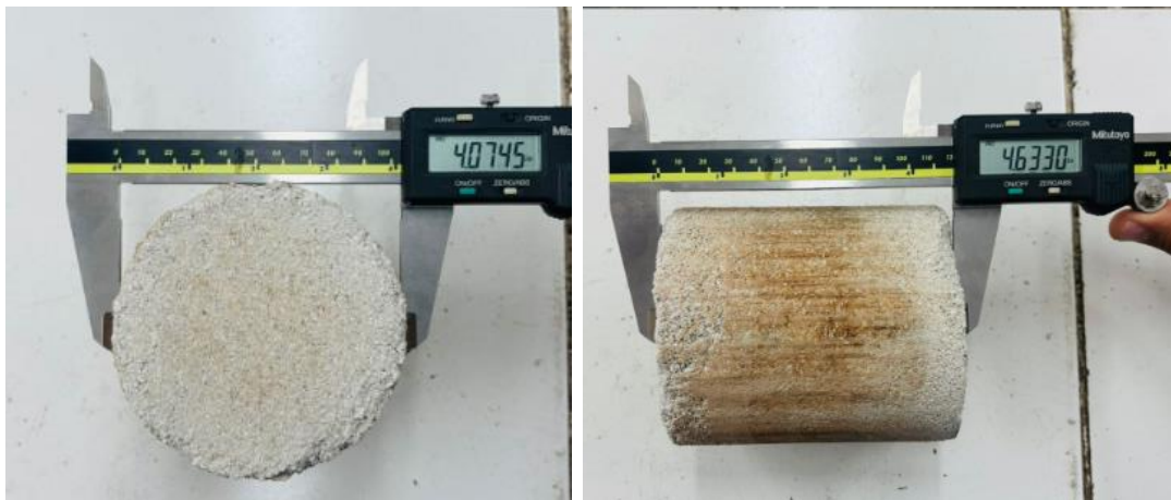
Ilustración 20 Briqueta de Suelo-Cemento (Método A)
