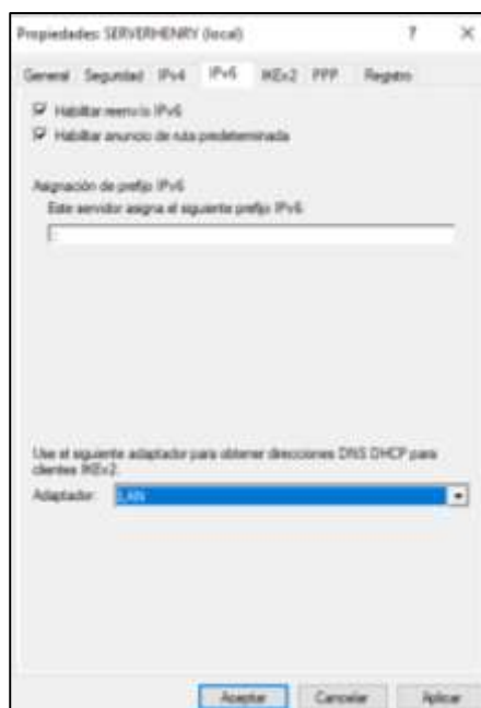
Figura 3.39 Configuración de reglas con IPV6
