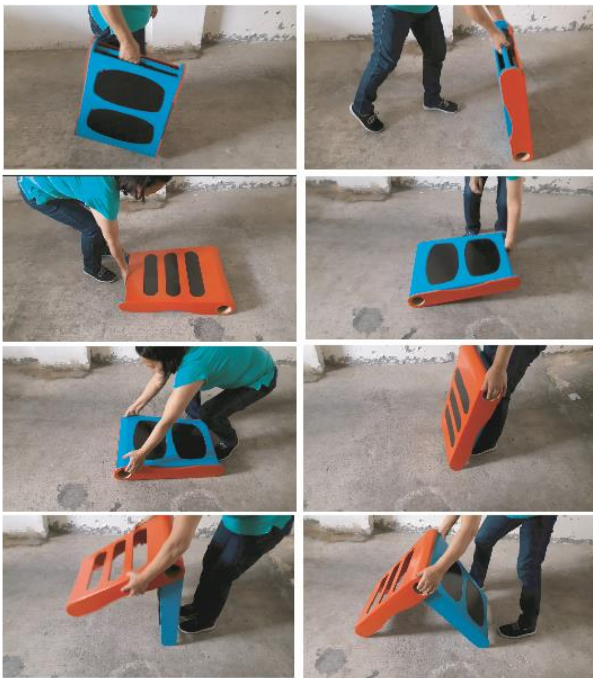
Imagen 22. 2do Modelo de estudio Escala 1 -1, Plegado y transporte
