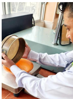
Ilustración 11: Pesaje de lo que retiene el tamiz #200
