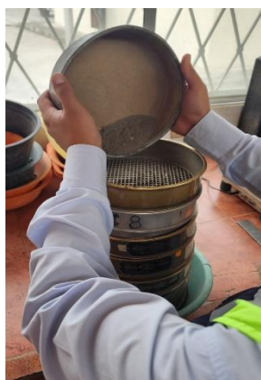
Ilustración 10: Ensayo de granulometría
