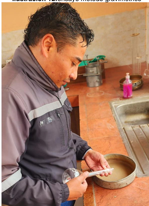
Ilustración 12: ensayo método gravimétrico
