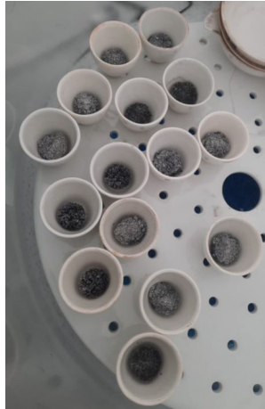
Figura 8: Determinación de Cenizas de las muestras de granola. Tomado por la Autora.
