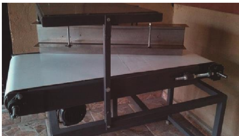
Figura 54: Brazo y banda de la divisora boleadora de banda lineal. Copyright 2015 por Ruelas
