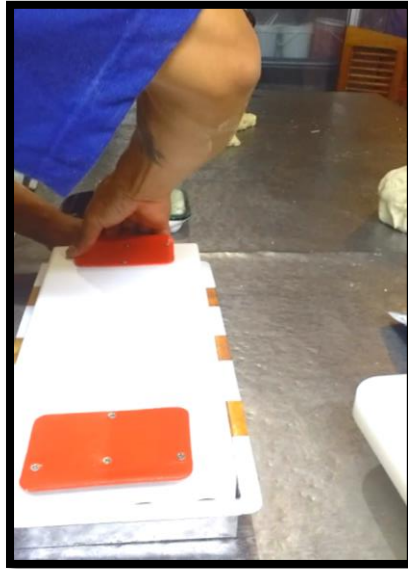
Figura 98: Retirado incorrecto de la prensa divisora desde uno de los extremos del objeto
