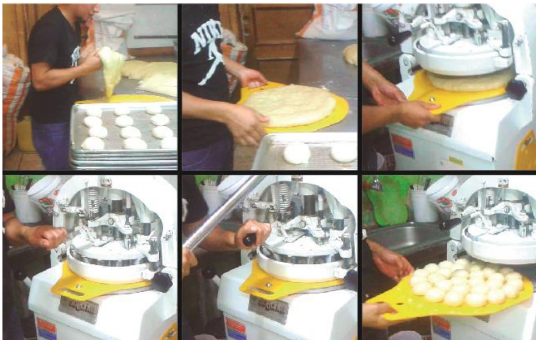
Figura 9: Proceso de funcionamiento de la divisora boleadora Fernetto
