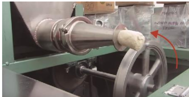
Figura 53: Extrusor de la divisora boleadora de banda lineal. Copyright 2013 por Manufacturas Lenin
