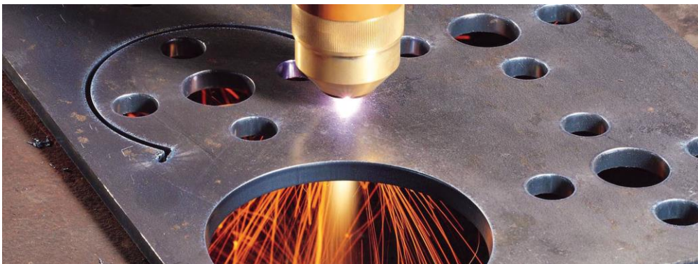
Figura 90: Corte de lámina de acero por plasma. Copyright (s.f) por Laser Mecafort
