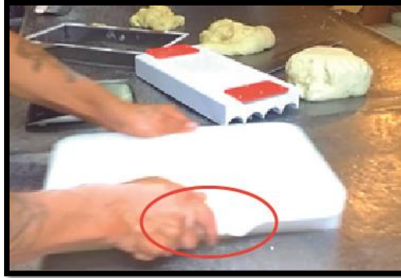
Figura 102: Manipulación incorrecta del boleador por parte del panadero
