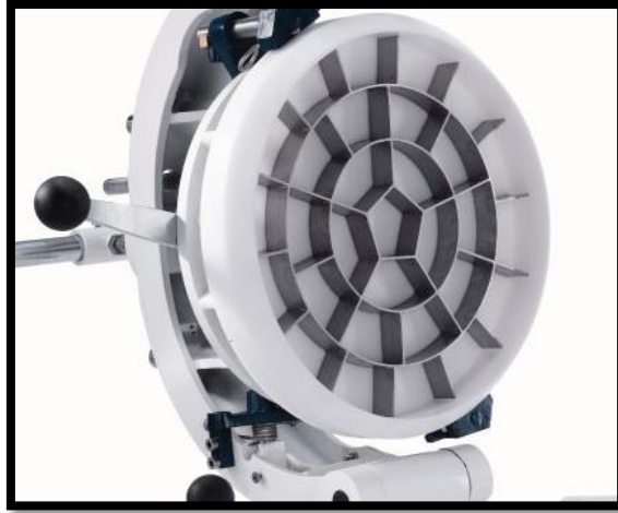
Figura 12: Sistema de división accionado por palancas. Copyright 2013 por Fernetto
