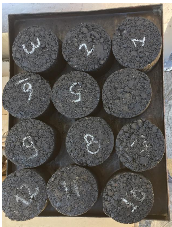
Ilustración 3.0.10 Briquetas de diseño con PVC (Iván Burbano, 2019)
