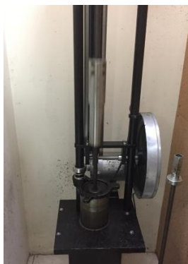
Ilustración 3.0.3 Compactador (Método Marshall) (Iván Burbano, 2019)
