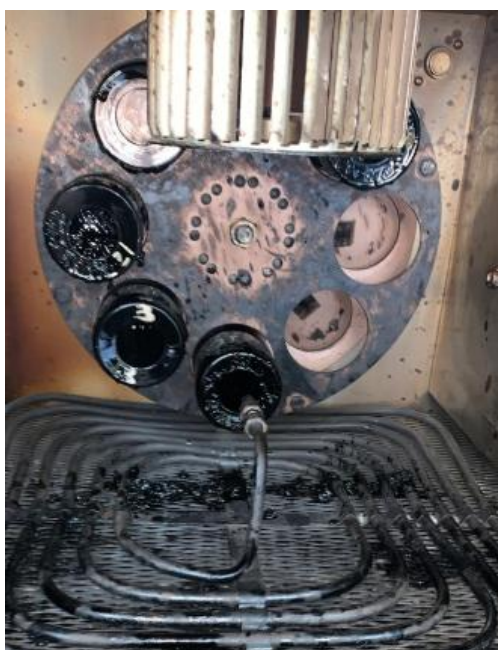
Ilustración 2.0.20 Ensayo Pérdida de masa en horno RTFO (Iván Burbano, 2019)
