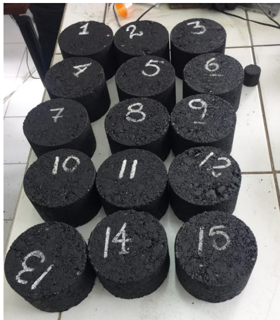
Ilustración 3.0.8 Briquetas 100% agregado 0.0% PVC (Iván Burbano, 2019)
