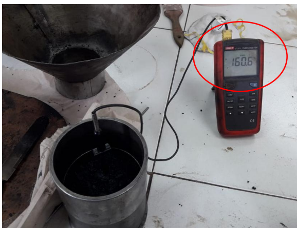
Ilustración 2.0.21 Control de temperatura para compactación y mezclado (Iván Burbano, 2019)
