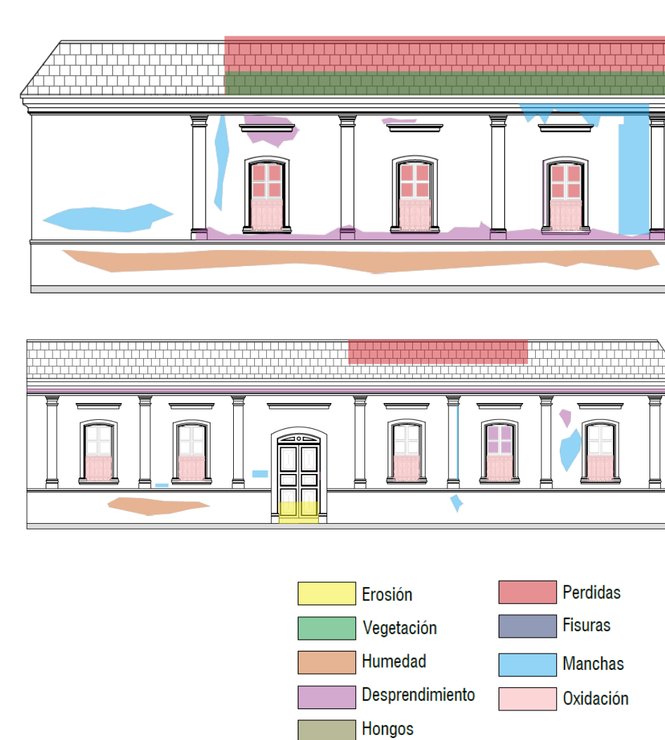
Figura. 73 Estado actual Fachadas del lote.
