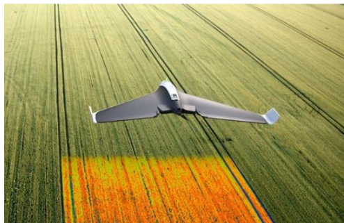
Figura 57. Ejemplo de dron de ala fija
