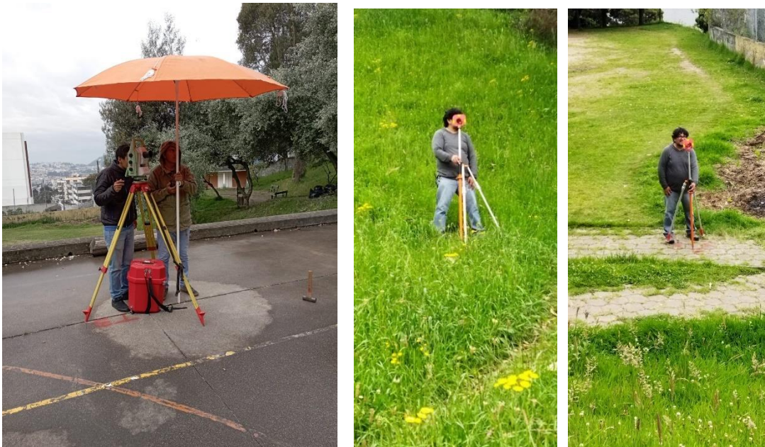
Figura 86. Medición de poligonales Fuente: Elaboración propia
