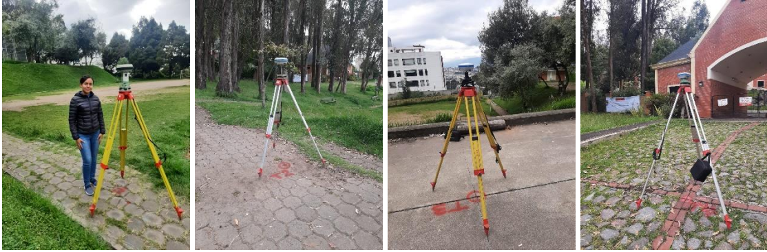
Figura 82. Colocación de puntos de control GNSS Fuente: Elaboración propia
