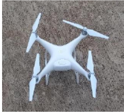
Figura 58. Ejemplo de un dron multirrotor cuadricóptero Phantom 4 Pro Fuente: (Tapia, Guevara, & Esquivel, 2019)
