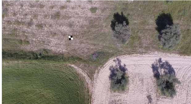
Figura 64. Ejemplo de colocación de un GCP
