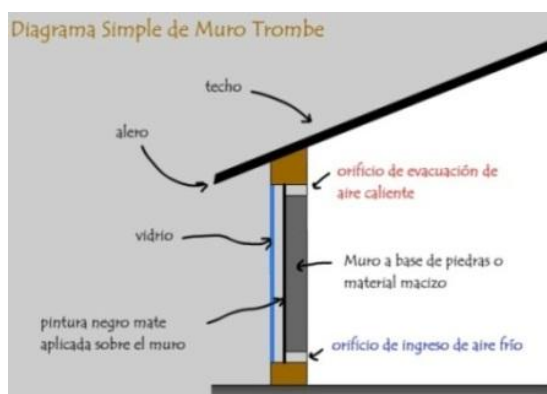
Imagen 2.6: Diagrama simple muro trombe
