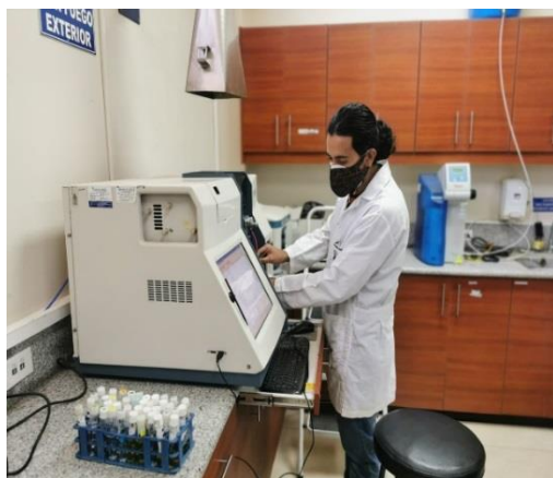
Figura 15. Medición de la concentración de metales en los lodos de la PTAR en el espectrofotómetro de absorción atómica
