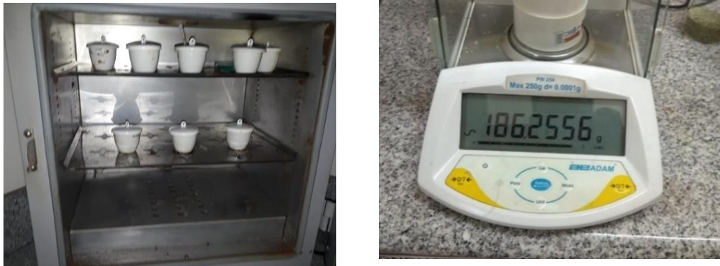
Figura 13. Secado y determinación del peso de la muestra de lodos de la PTAR de los laboratorios de la ECAA.
