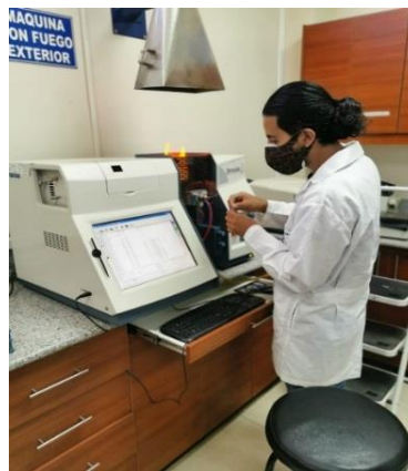
Figura 15. Medición de la concentración de metales en los lodos de la PTAR en el espectrofotómetro de absorción atómica
