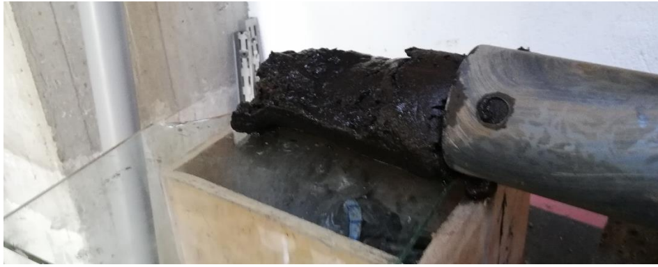
Fotografía 12 Muestra del metro 9 a 9.15 utilizado para el ensayo de granulometría.
