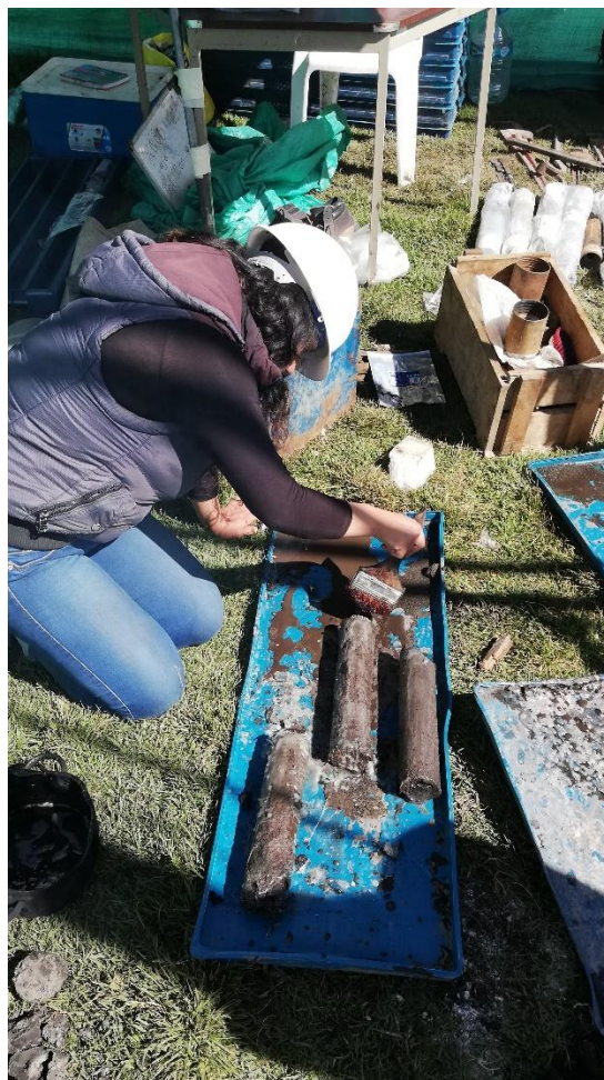
Fotografía 5 Muestra obtenida por barril seco
