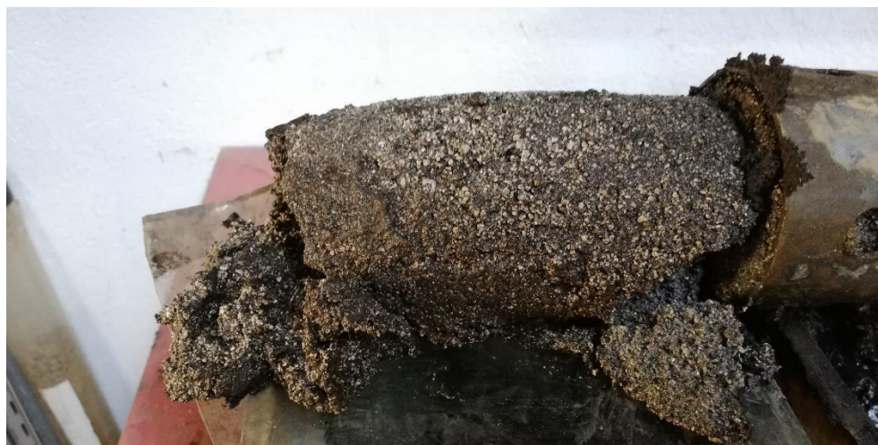
Fotografía 13 Muestra del metro 15.30 a 15.45 utilizado para el ensayo de granulometría.
