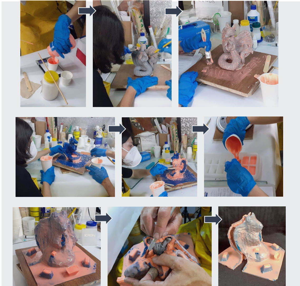
Figura 59. Proceso de fabricación de molde para art toy del dios Amaru
