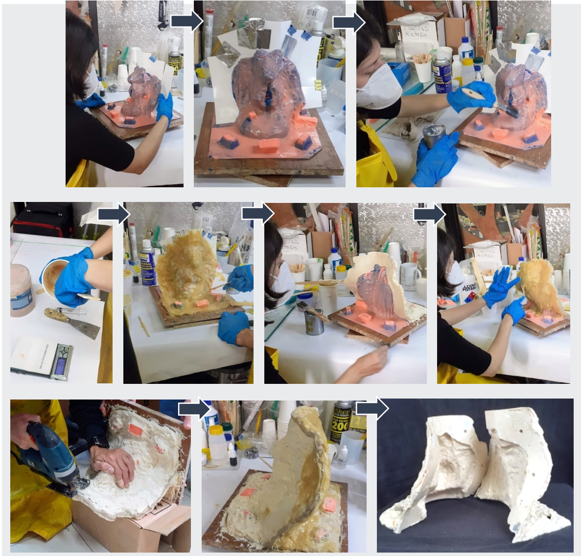
Figura 60. Proceso de fabricación de contramolde para art toy del dios Amaru
