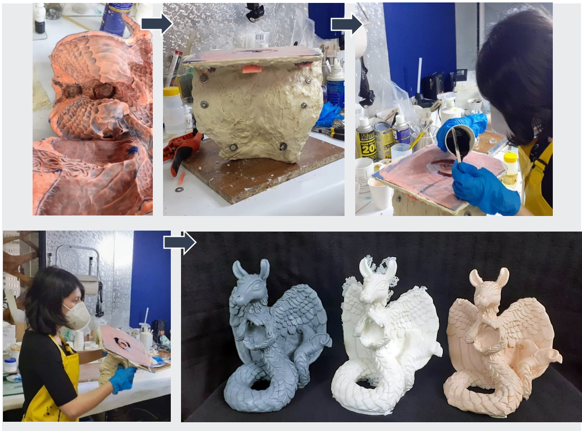
Figura 61. Proceso de reproducción en resina de poliuretano del dios Amaru
