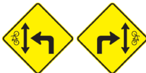
Ilustración 22: Señalización para carril de Cruce de bicicletas al virar
