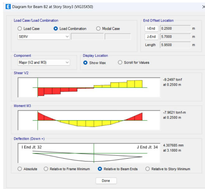
Figura 149 Deflexión en Viga – Combo Servicio – Modelo Lineal
