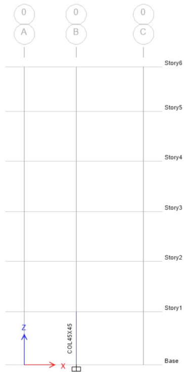
Figura 164 Distribución de elementos en pórtico 0
