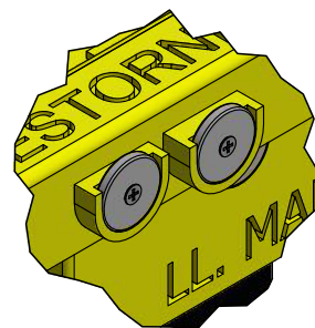
Detalle Y: Imanes neodimio Escala 1:2
