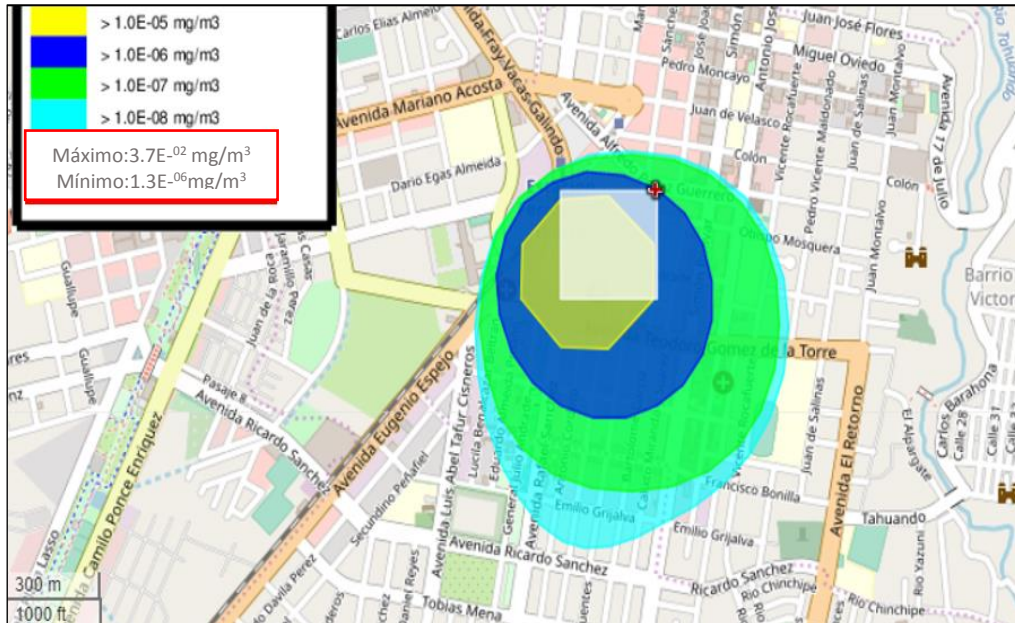
Figura 41. Concentración y dispersión del contaminante CO 2 de lunes – jueves, para el punto de estudio 2
