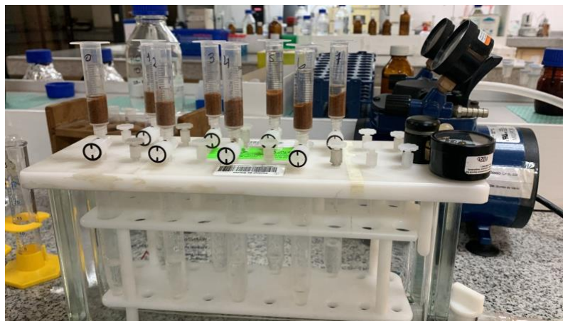
Figura 21. Proceso de percolación de soluciones a través de las columnas.
