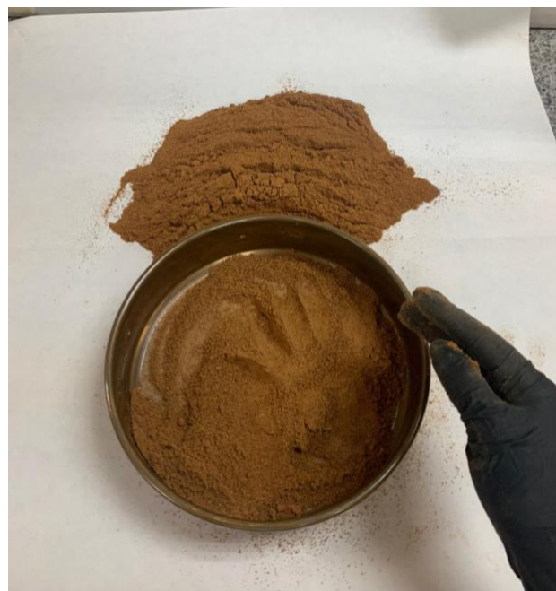
Figura 18. Proceso de tamizado de la biomasa
