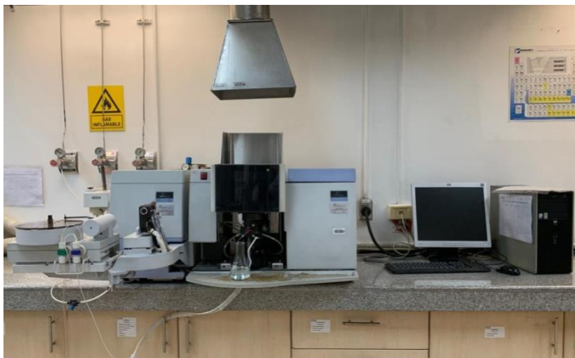
Figura 2. Equipo de espectroscopía de absorción atómica de llama
