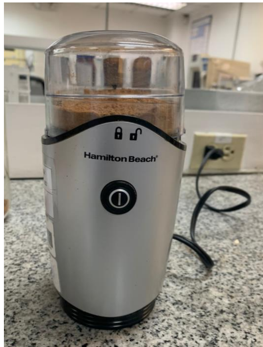
Figura 17. Molino empleado en la trituración de la biomasa
