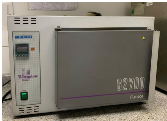
Figura 24. Mufla empleada en el análisis de cenizas
