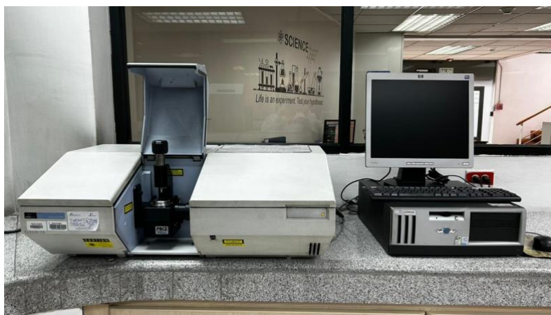
Figura 1. Equipo de espectroscopía infrarroja FTIR-ATR.
