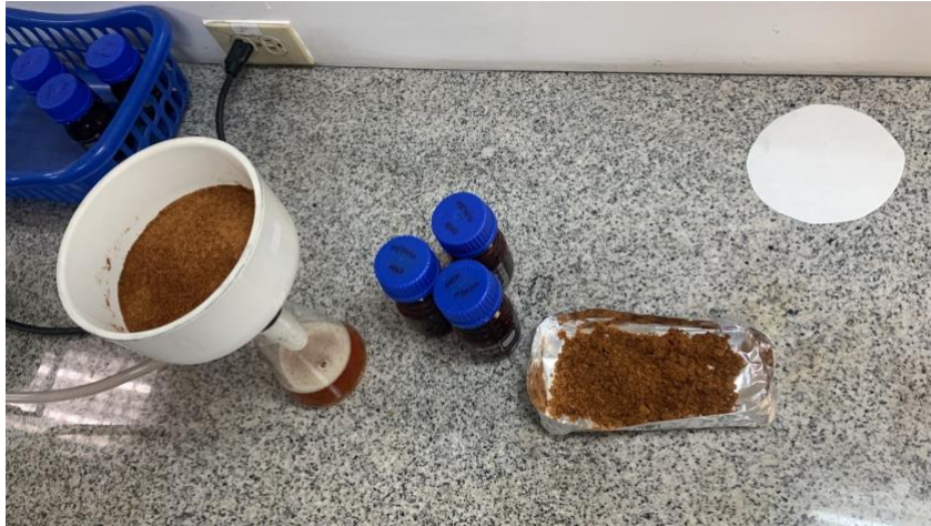
Figura 19. Proceso de filtración de la biomasa después del pretratamiento
