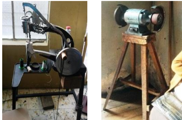
Figura 21: A) Máquina para clavar planta, B) Máquina pulidora Fuente: Calzado Verdezoto & Calzado Pilco
