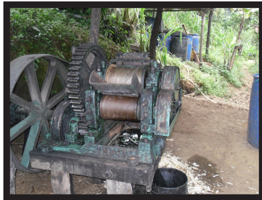
Tradición Trapiche, donde se muele la caña de azúcar para la obtención del Guarapo
