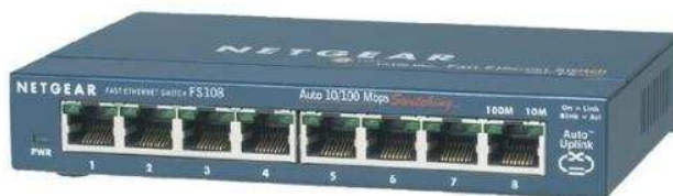
Figura 2.21 Switch de 8 Puertos
