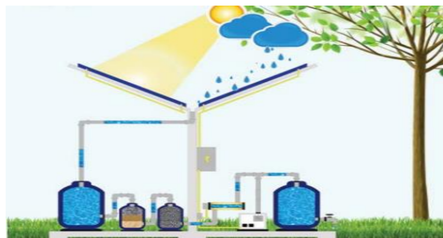
Figura 34: Sistema de potabilización de aguas lluvias. Fuente: Documento de la Universitaria Agustiniiana Bogotá, Colombia
