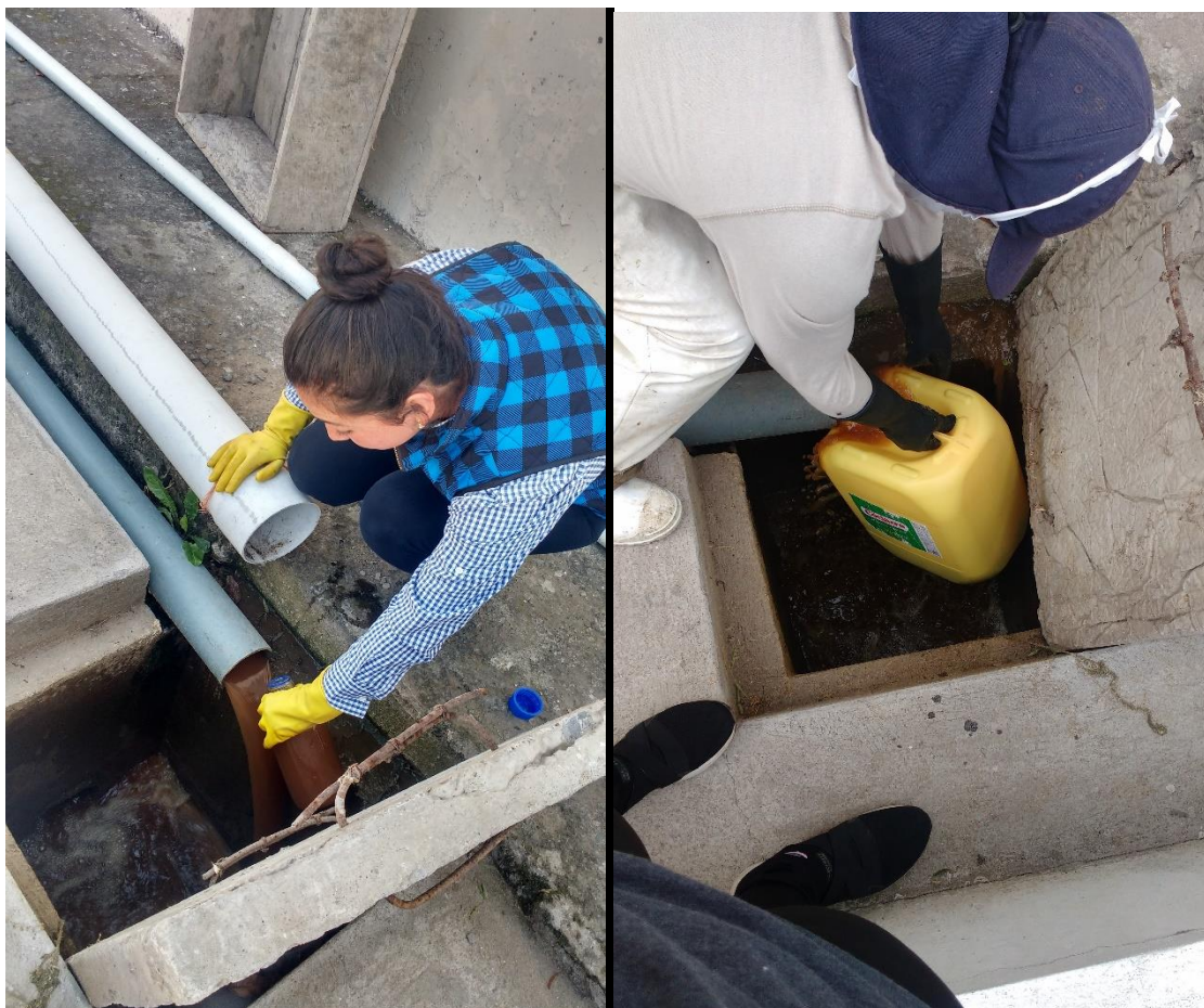
Anexo 7. Riego del agua residual en los vermifiltros.
