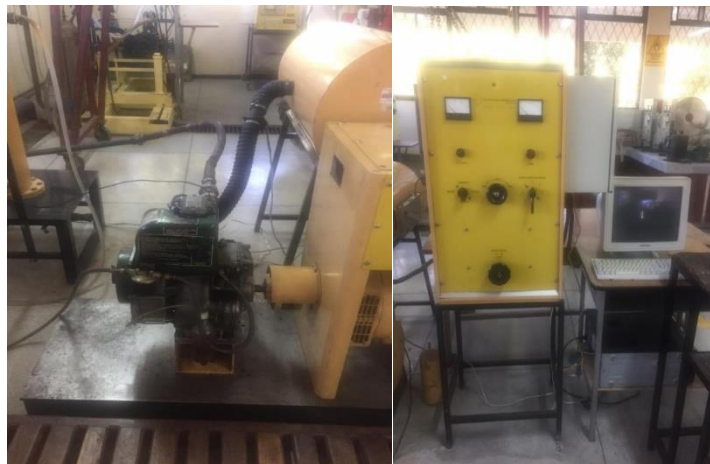
Figura 7 Banco de Pruebas de motores PLINT TE-46
