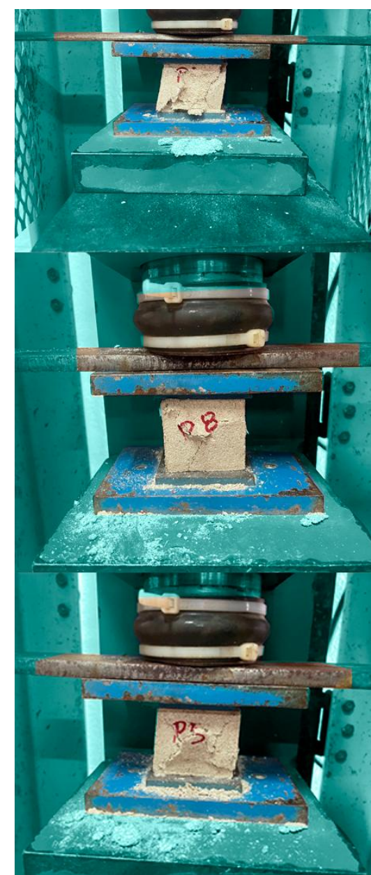
Probetas de compresión colapsadas
