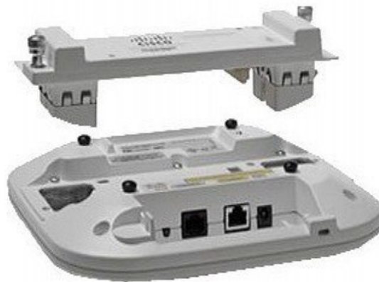
Figura 19. Ejemplo Modulo CISCO WSM AIR-RM3000M
