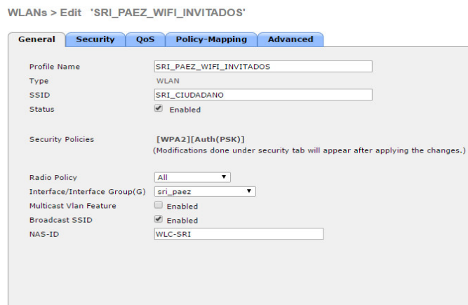
Figura 33. Configuración General SSID “SRI_CIUDADANO”
