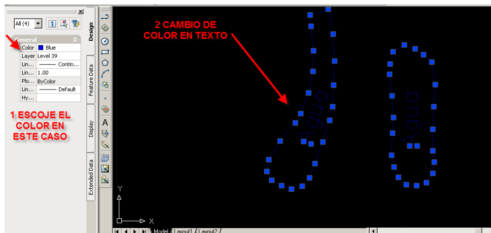
Imágen 58: Cambio de color de textos con el uso de la herramienta de propiedades
