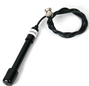
Ilustración 38: Sensor de Oxígeno Disuelto Foto: Christian Guerrero
