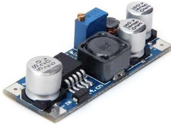
Ilustración 32: Tarjeta Reguladora de Voltaje Foto: Christian Guerrero
