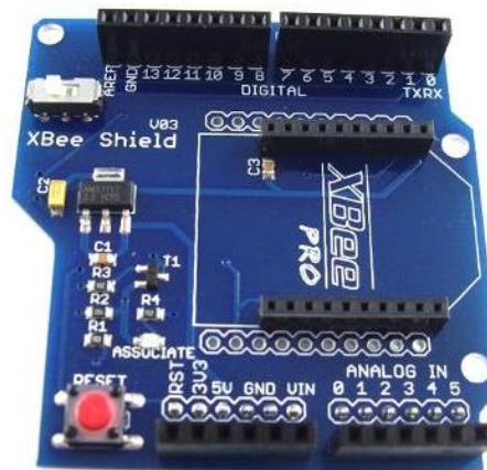
Ilustración 47: Xbee Shield Foto: Christian Guerrero
