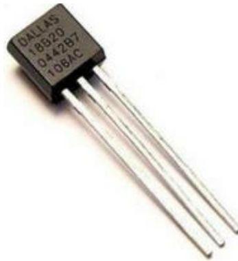
Ilustración 40: Sensor de Temperatura 18B20 Foto: Christian Guerrero
