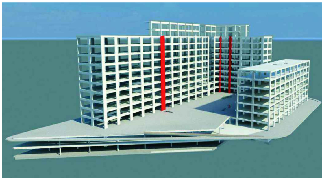
Fotografía 22: Perspectiva de columnas vigas y losas alivianadas.
