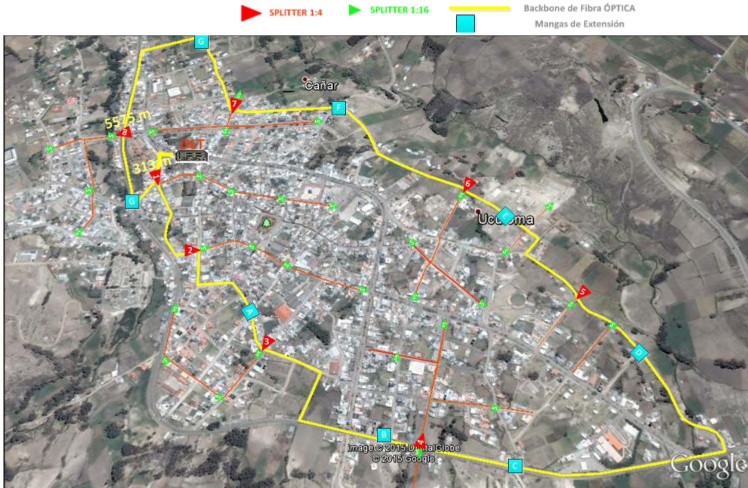
Figura 22 Diagrama Físico de la Red Gpon para el ISP TroncalNet en el cantón Cañar 24
