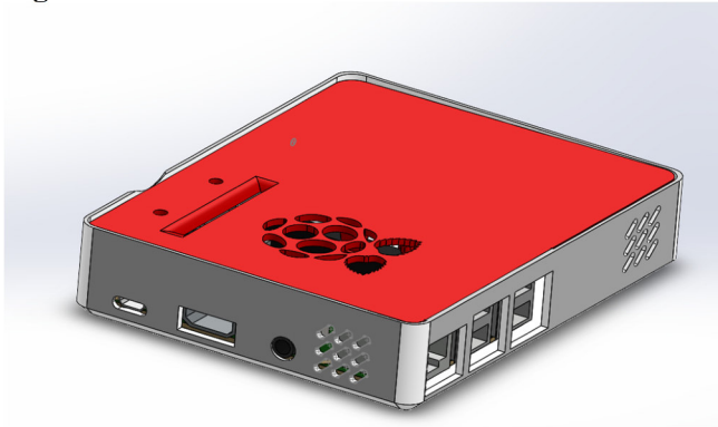
Figura 24. Carcasa realizada en Freecad
