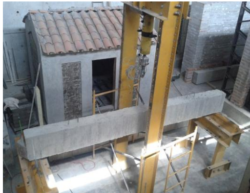
Foto 15 Viga apoyada en marco de carga
