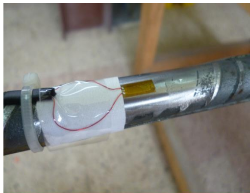
Foto 11 Strain gage en varilla de viga HAREFC 4
