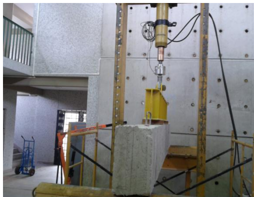
Foto 16 Montaje de viga de reparto sobre viga de hormigón armado
