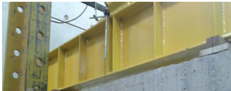
Foto 10 Incorporación de deformímetro LVDT
