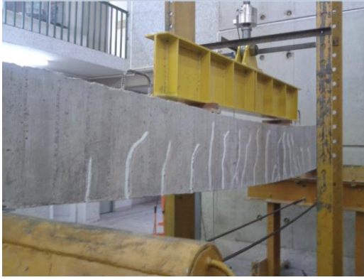
Foto 34 Grietas en cara posterior de viga
