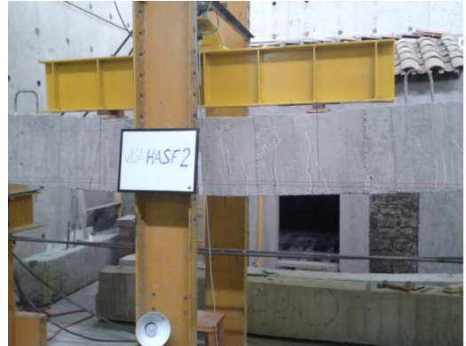
Foto 50 Grietas en cara frontal de viga
