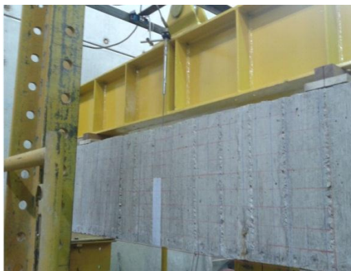
Foto 6 Preparación de viga de reparto
