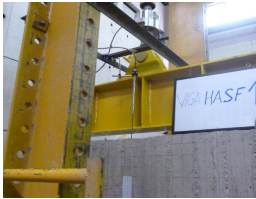
Foto 17 Viga con instrumentación completa
