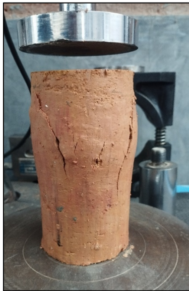
Fotografía 20. Muestra después de ensayar con tipo de falla
