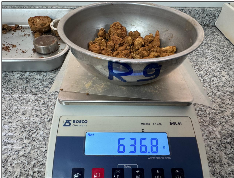
Fotografía 17. Peso de muestra para cálculo de contenido de humedad
