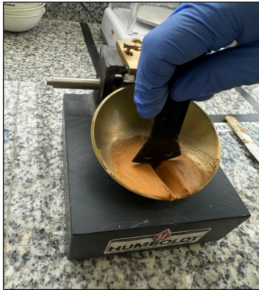
Fotografía 11. Verificación de altura de la muestra colocada en la copa.
