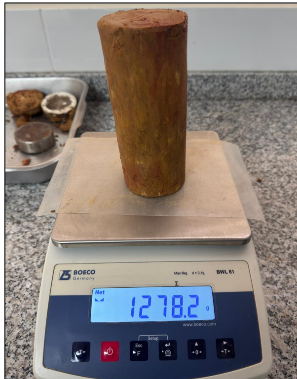
Fotografía 16. Muestra inalterada pesada
