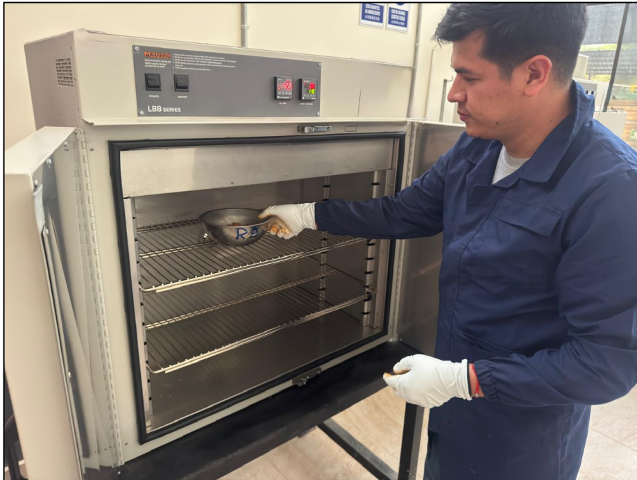
Fotografía 9. Dsecación en horno
