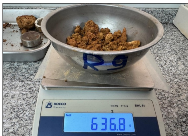
Fotografía 8. Determinación del peso
