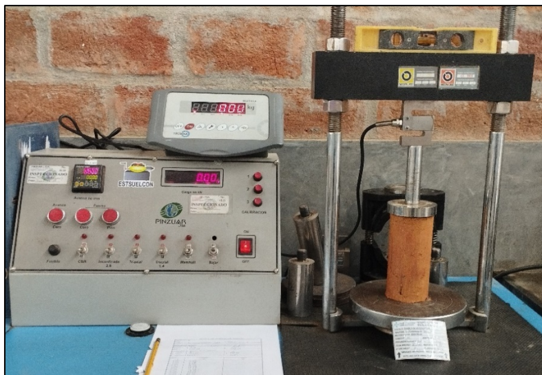
Fotografía 18. Montaje en prensa de muestra inalterada
