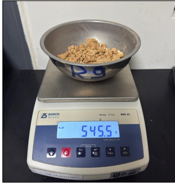
Fotografía 10. Enfriamiento y pesaje final
