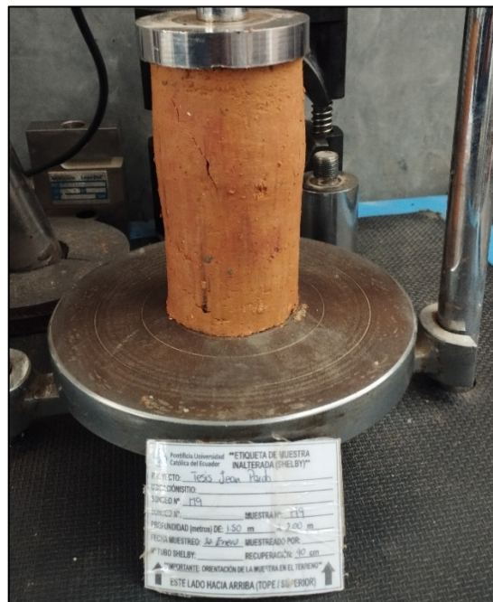
Fotografía 19. Aplicación de carga sobre probeta
