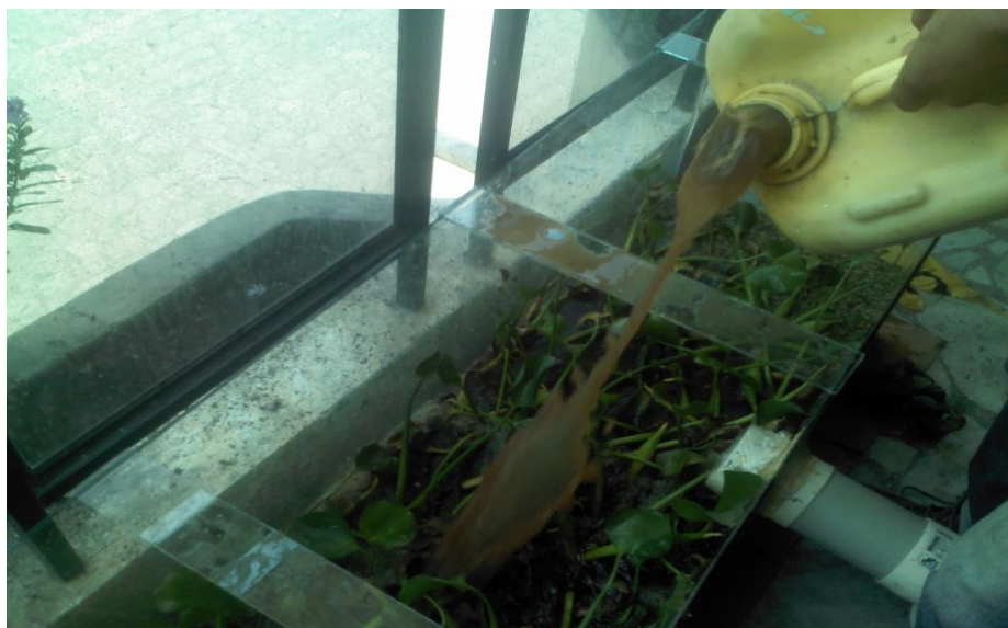
Fotografía 36. Llenado de la planta piloto con agua residual.
