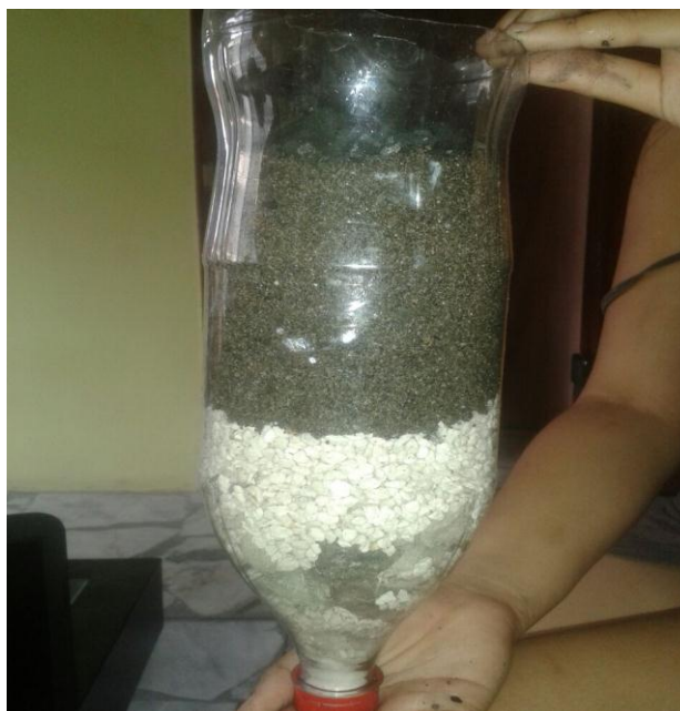
Fotografía 6. Filtro de grava.
