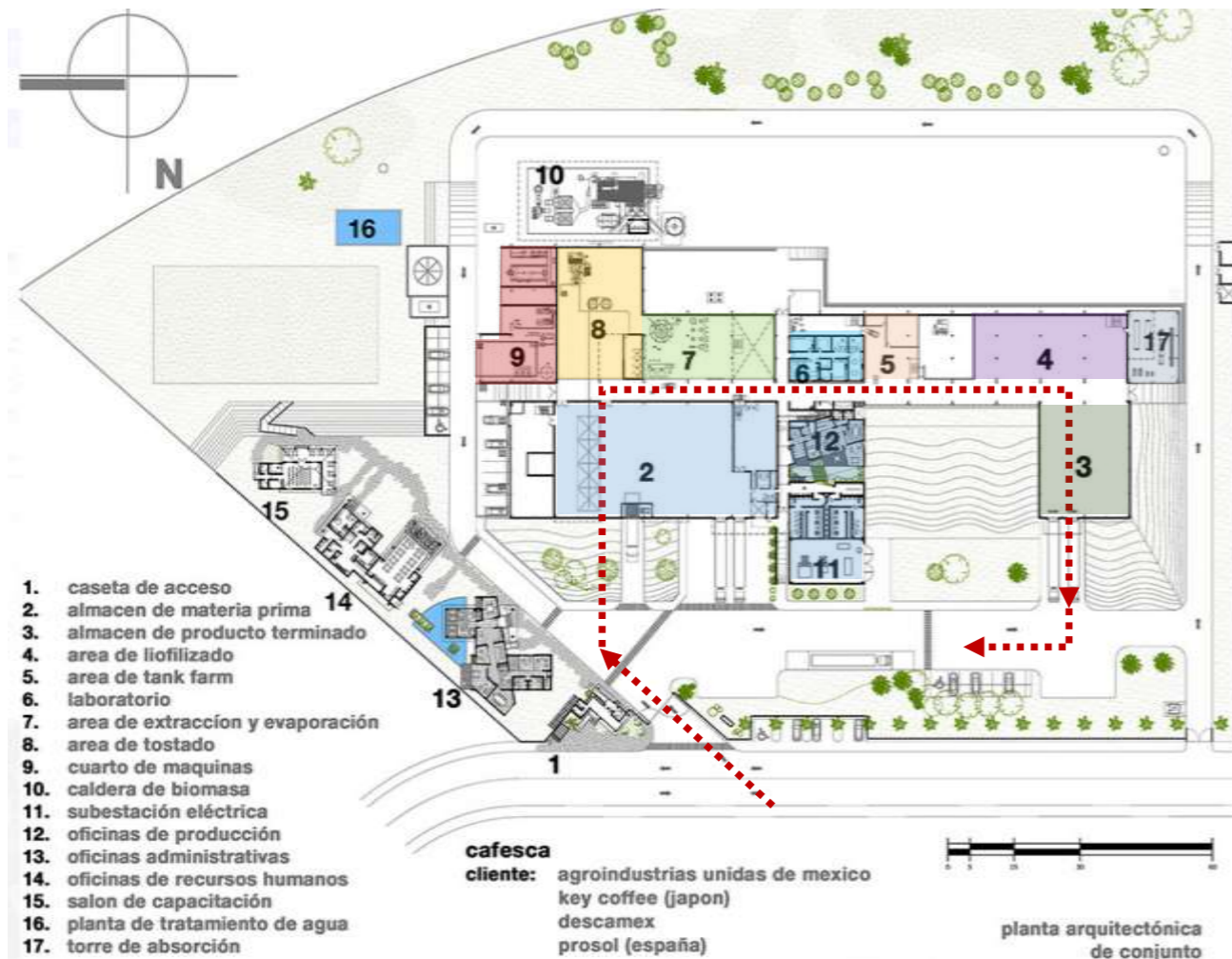
Figura 15 Planta baja arquitectónica Planta liofilizadora de café Fuente: (BAQ, 2016)
