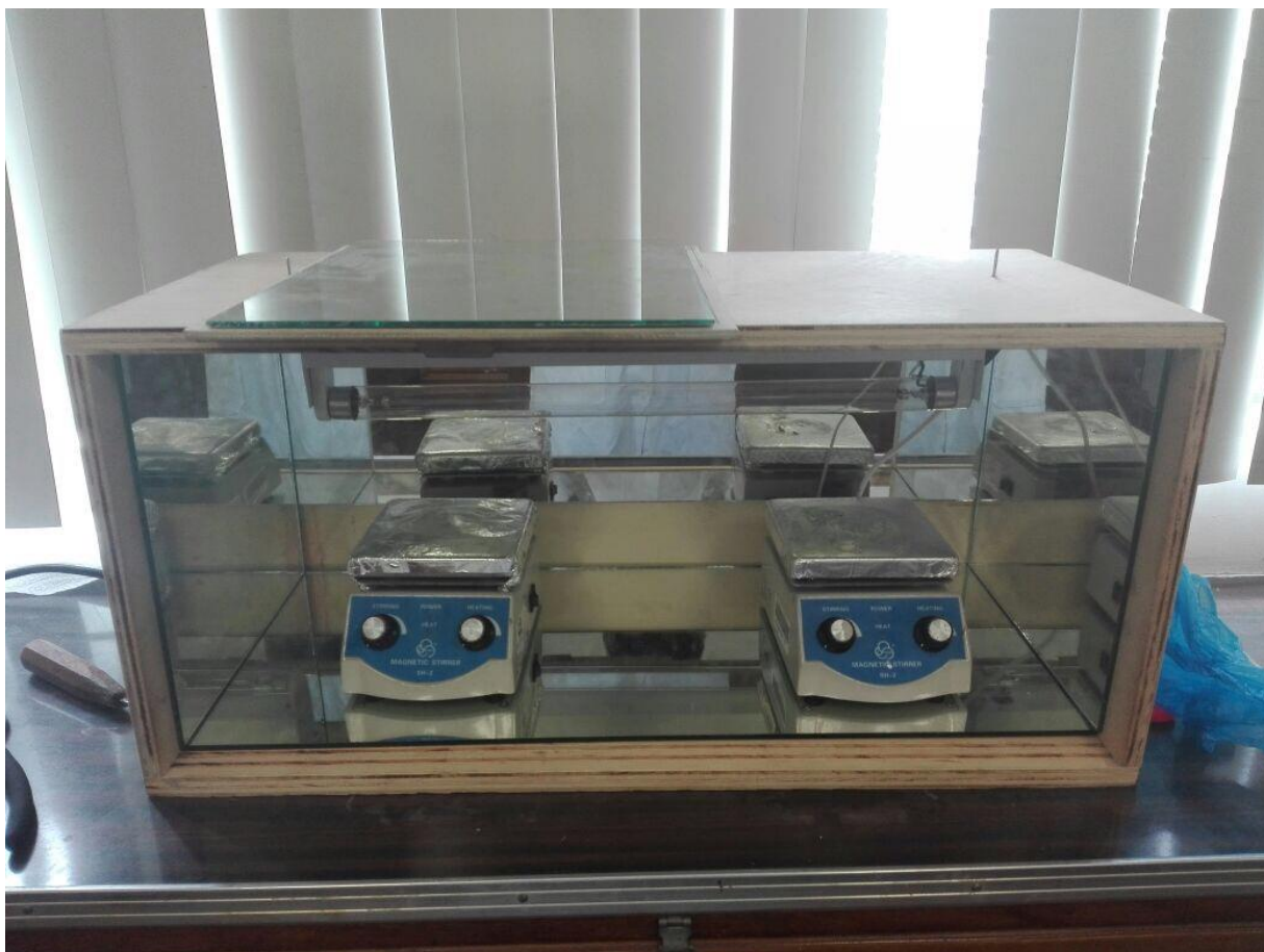
Anexo 2. Reactor cerrado para fotocatalisis tipo batch con agitadores magnéticos en su interior
