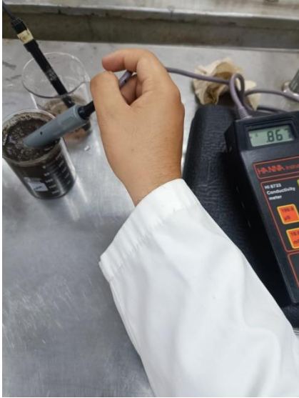
FOTOGRAFÍA 7: MEDICIÓN DE PH Y CONDUCTIVIDAD EN LAS MUESTRAS DE BIOSÓLIDO MEZCLADO CON TIERRA
