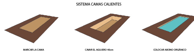
Gráfico 5 Esquemas preparación camas calientes
