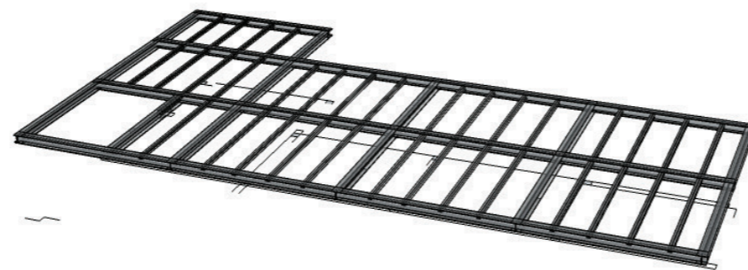
3D ESTRUCTURAL ARMADO DE LOSA
