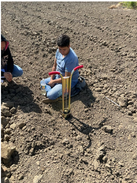
Imagen 3 Prueba de Infiltración
