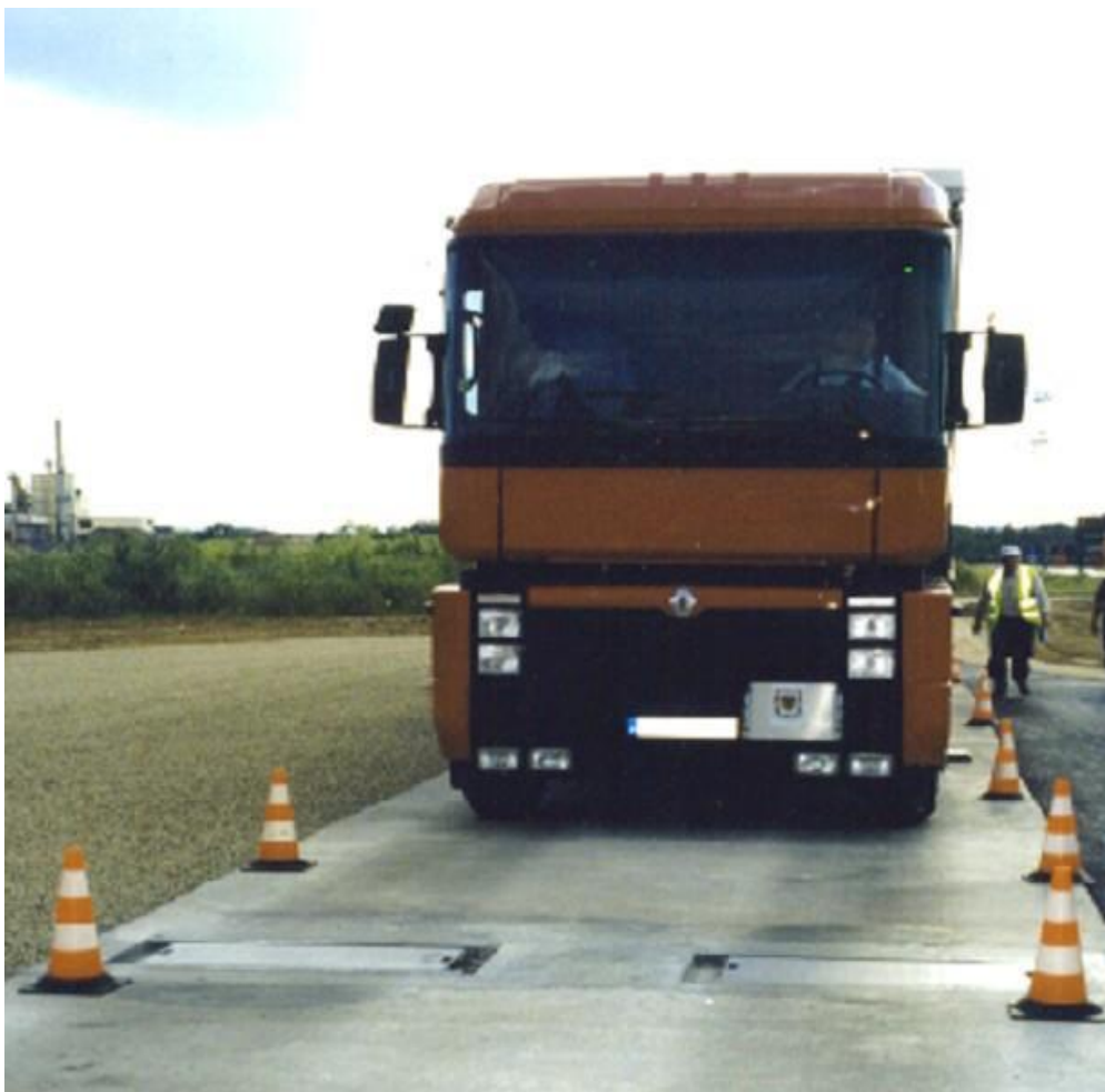
Gráfico 3. 2 Báscula Fija para pesaje
