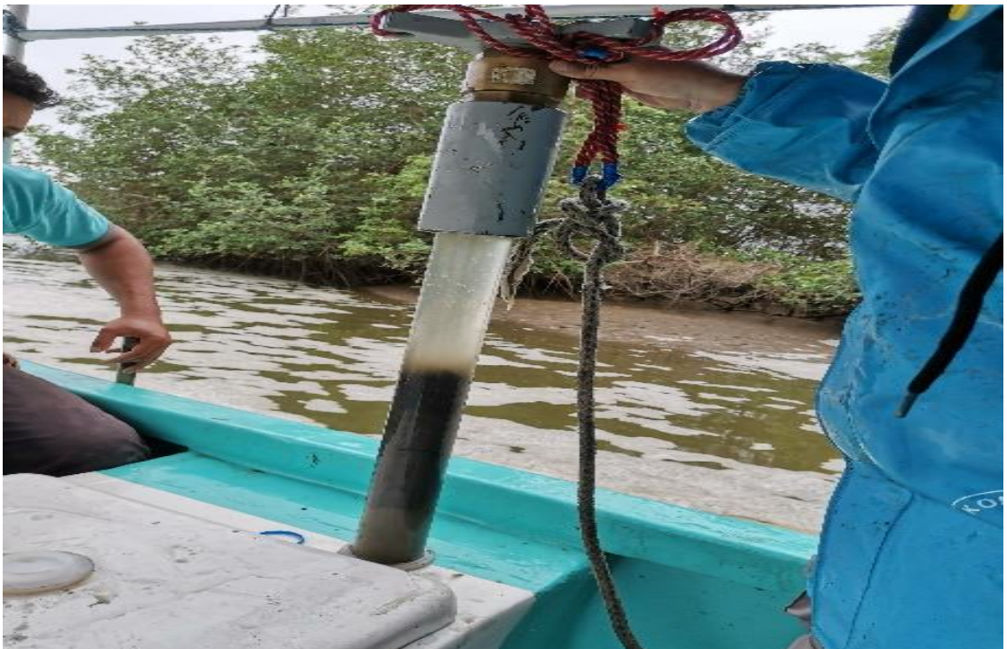
Figura 13. Sacatestigos o gravity Core
