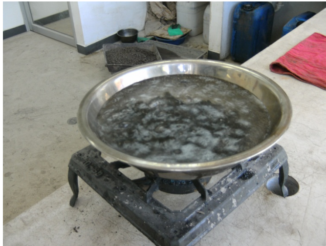
Foto 40.- Ensayo de peladura por el Método del Hervido.
