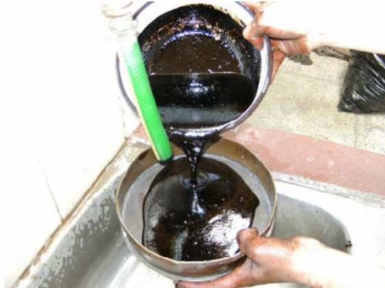
Foto 19.- Proceso de lavado mediante el tamiz # 20.
