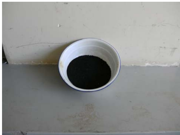
Figura 5.- Escorias siderúrgicas a utilizarse en las mezclas asfálticas en frío.
