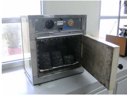
Foto 27.- Especímenes secos al horno. Foto 28.- Determinación de pesos.
