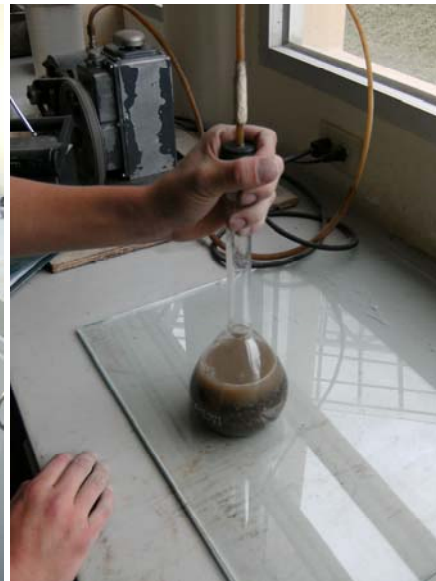
Foto 13.- Gravedad específica fina
