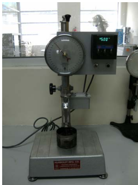
Foto 23.- Ensayo de penetración del residuo.
