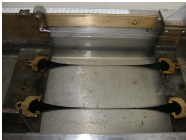
Foto 24.- Ensayo de ductilidad del residuo.
