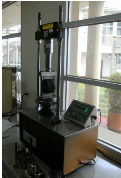
Foto 38.- Prueba de tracción indirecta.
