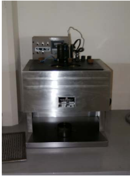
Foto 20.- Ensayo de viscosidad de la emulsión.
