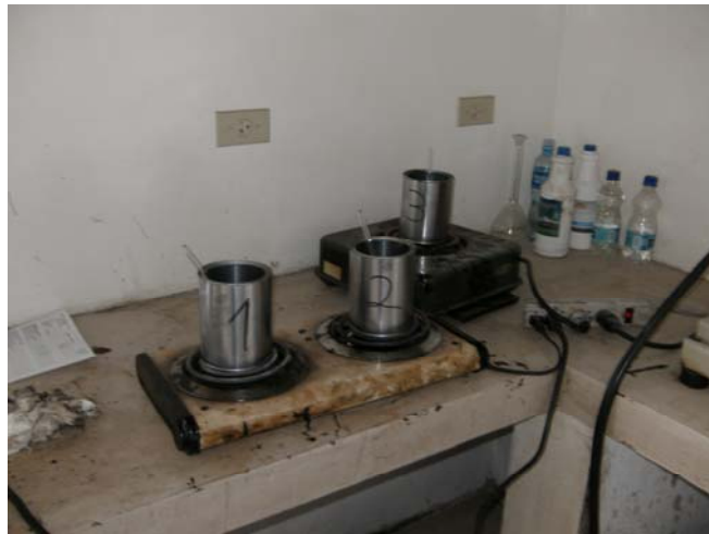
Foto 21.- Proceso para determinar el residuo por evaporación.
