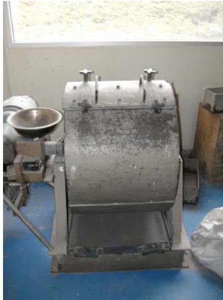
Foto 11.- Maquina de los Ángeles utilizada para el ensayo de desgaste.
