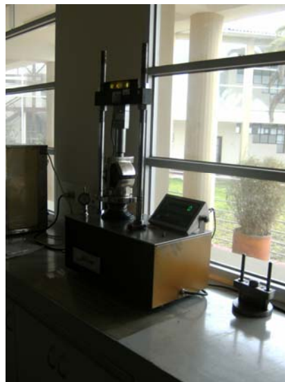
Foto 30.- Ensayo de estabilidad y flujo.
