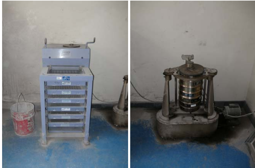
Foto 8.- Granulometría agregado grueso.
