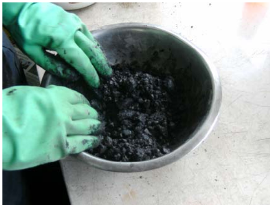
Foto 31.- Mezcla fría emulsificada de asfalto–agregado.
