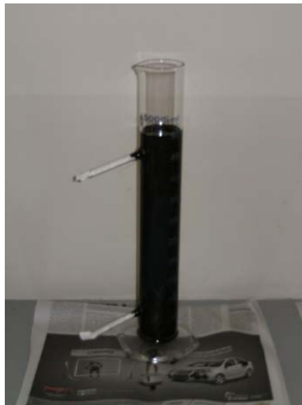
Foto 22.- Estabilidad a las 24 horas de la emulsión.
