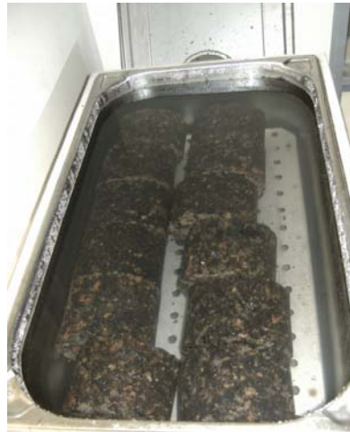
Foto 29.- Especímenes en baño María a 25\text{ }^{\circ}\text{C} .
