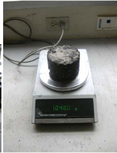
Foto 27.- Especímenes secos al horno. Foto 28.- Determinación de pesos.
