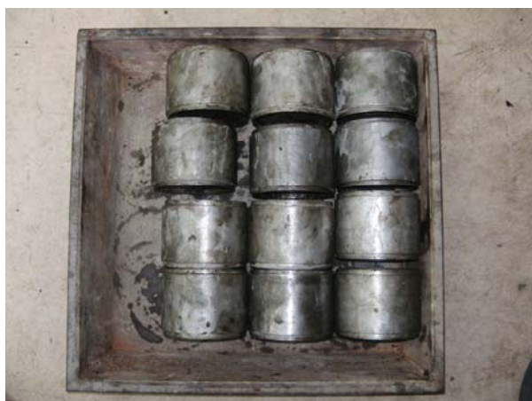
Foto 36.- Especímenes secados al aire por 24 horas.
