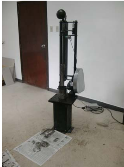
Foto 35.- Pedestal de compactación.
