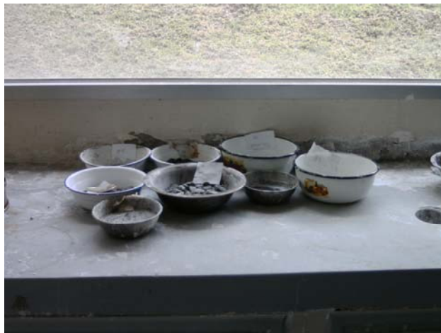
Foto 14.- Ensayo de durabilidad de los agregados a la acción de los sulfatos.
