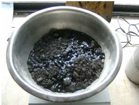
Foto 33.- Porcentaje óptimo de emulsión en la mezcla de agregado pétreo.
