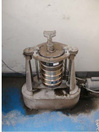
Foto 25.- Proceso para tamizar las escorias siderúrgicas.
