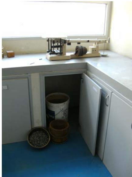
Foto 12.- Gravedad específica grueso.
