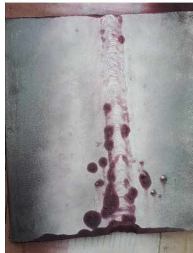
Figura 32: Porosidades visibles con líquidos penetrantes, probeta 2 Fuente: Propia
