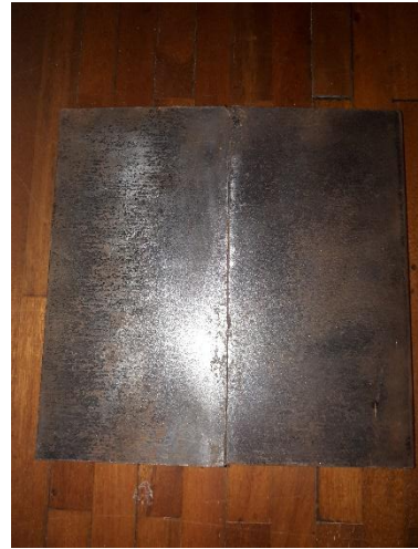
Figura 30: Falta de penetración probeta 1 Fuente: Propia
