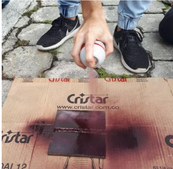
Figura 16: Colocación del líquido penetrante
