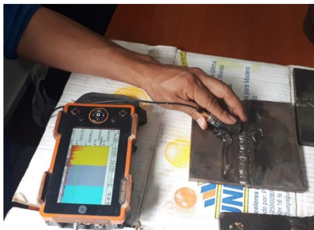
Figura 28: Inspección de soldadura mediante ultrasonido.
