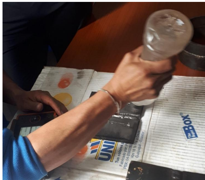
Figura 26: Colocación de gel previo al barrido Fuente: Propia
