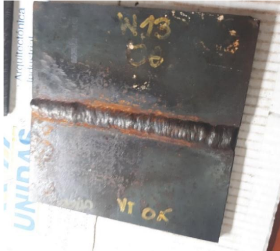
Figura 38: Ejemplo de soldadura realizada correctamente
