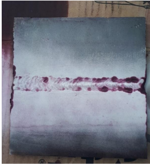
Figura 20: Discontinuidades una vez seco el revelador
