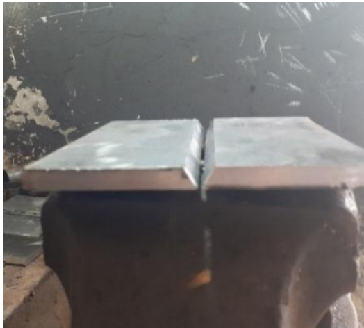
Figura 11: Ranura tipo V con un ángulo total de 60 grados y separación de 2mm
