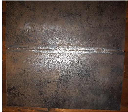
Figura 35: Penetración incompleta probeta 2 Fuente: Propia
