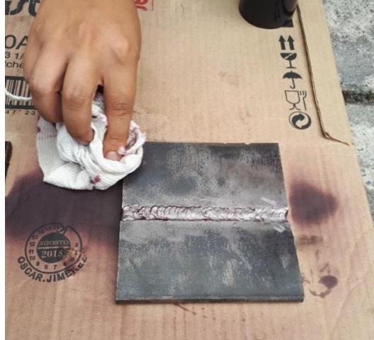
Figura 18: Limpieza del exceso de penetrante con el líquido limpiador
