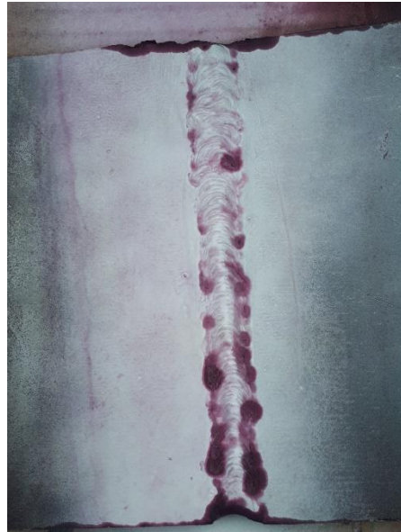
Figura 37: Inspección con líquidos penetrantes probeta 2 Fuente: Propia
