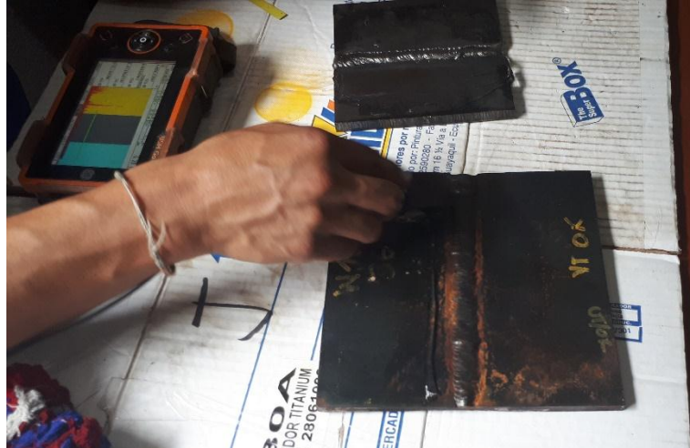
Figura 45: Inspección de una soldadura sin discontinuidades Fuente: Propia
