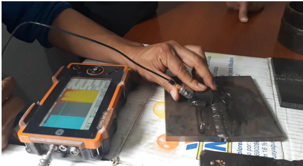
Figura 40: Inspección por ultrasonido Fuente: Propia
