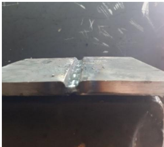
Figura 12: Realización del primer cordón de soldadura
