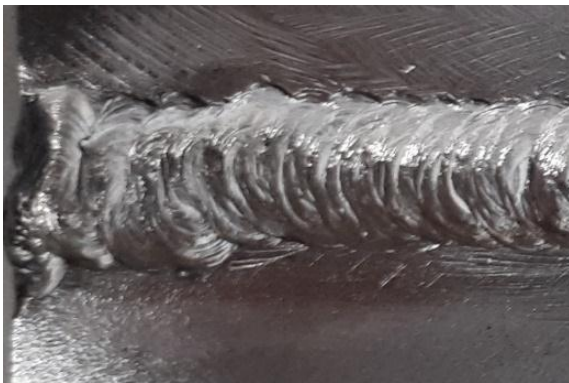
Figura 33: Falta de fusión Fuente: Propia
