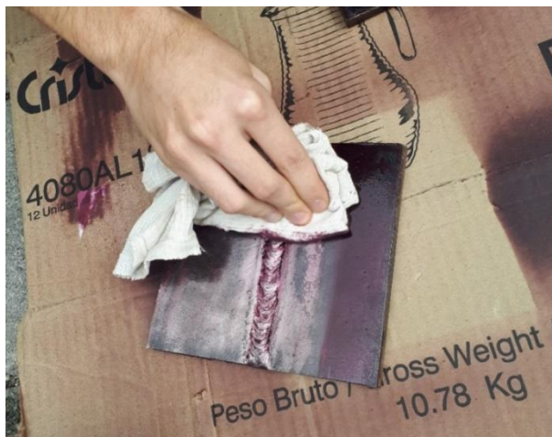
Figura 17: Remoción del exceso de líquido penetrante de la superficie
