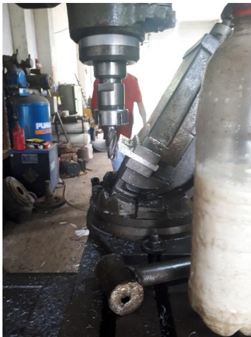
Figura 10: Biselado de las placas de acero
