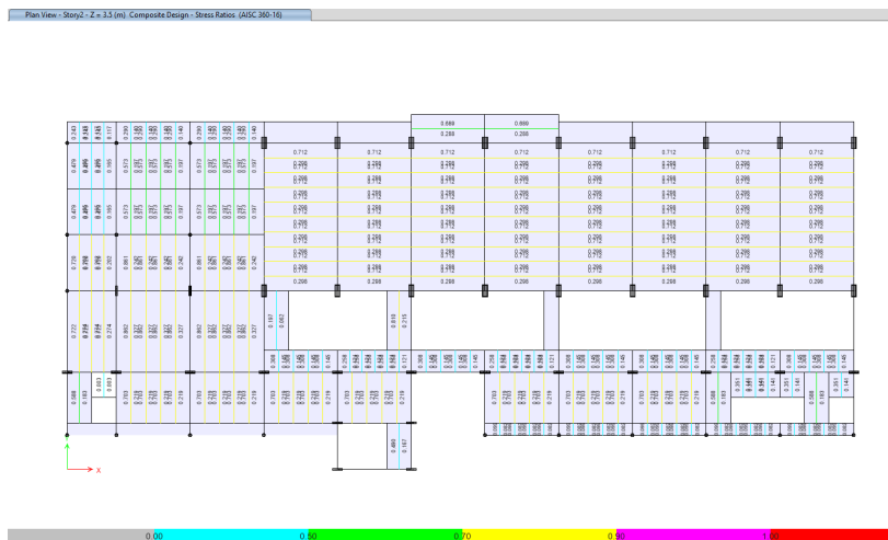
Figura 31. Relación Demanda/Capacidad – Vigas secundarias
