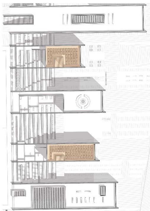
Figura 87: Ubicación de los paneles fotovoltaicos en el proyecto. Elaborado por: Jaire Cagigal
